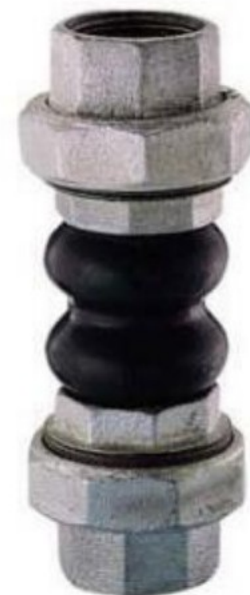
Компенсатор антивибрационный муфтовый Genebre 2830, FC6, EPDM , 700L, Tмакс.= 105°C
